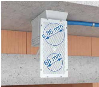
Platine avant avec diamètre d'encastrement 68 mm à enfoncer ou jusqu'à Ø 86 mm à fraiser
