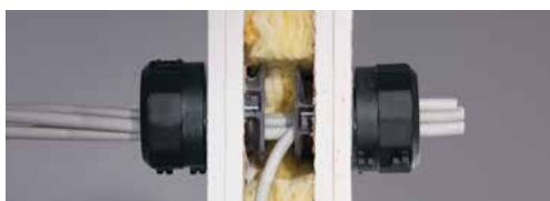
Ø perçage : 74mm Ø câbles : • Faisceau : max 40 mm. Ø maxi du plus gros câble 15 mm • Câble unique : max 21 mm • Conduit : max 40 mm
