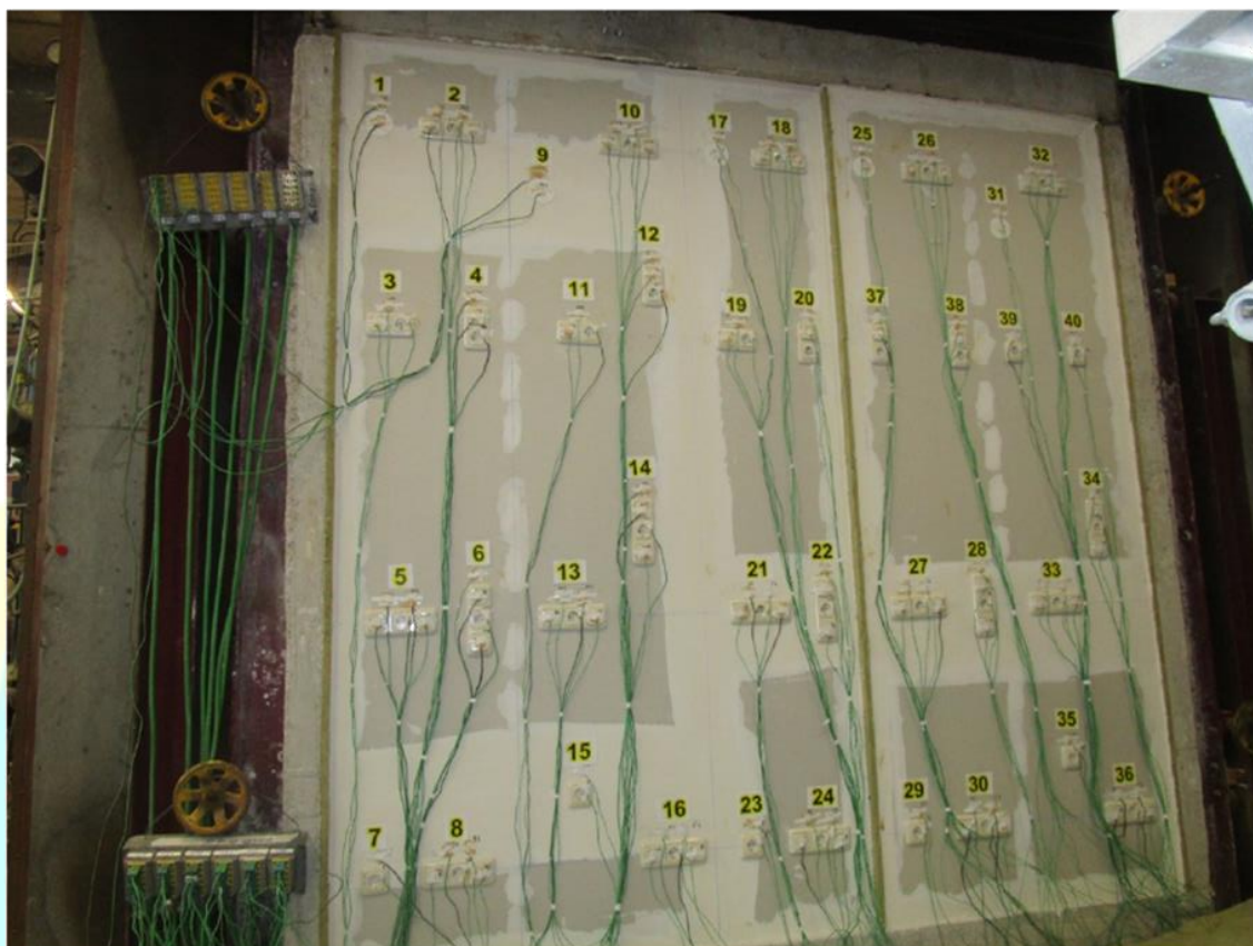
Échantillon d'essai avant la simulation d'incendie le 21/01/2016 Côté air
